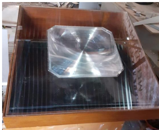
Gambar 2 Sistem Desalinasi menggunakan Lensa Fresnel
